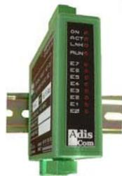
Il fonctionne sous protocole **Modbus TCP** en maître ( fonction miroir) ou en esclave, **SNMP** agent.
